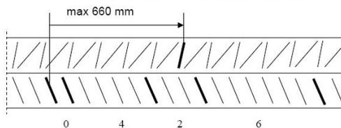
ovvero, con diversa disposizione delle nervature
