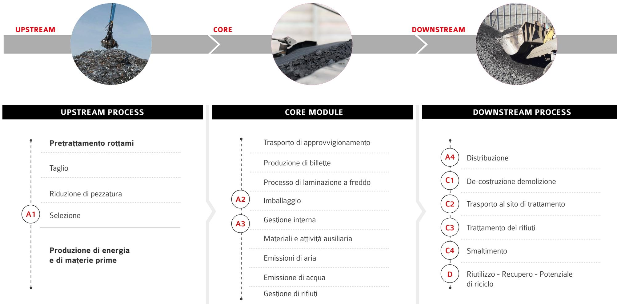
Schema generale Prodotti in acciaio laminati a caldo per cemento armato, in cui le principali attività incluse nei confini del sistema sono elencate e divise nei tre sottosistemi: UPSTREAM Process, CORE Module e DOWNSTREAM Process.
