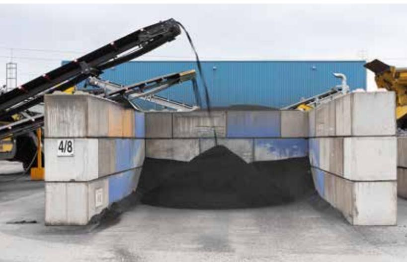
ALFA SINSTONE®, GRIPSTONE® e SICILYSTONE sono sottoprodotti che si ottengono dalla valorizzazione della scoria nera di acciaieria composta prevalentemente da ossidi di ferro, calcio e silicio, che si genera durante il processo di fusione dei rottami ferrosi nel forno elettrico. Si tratta di aggregati artificiali ad alte prestazioni nati dalla ricerca continua di nuovi materiali e nuove tecnologie per il miglioramento dei manufatti e la salvaguardia delle risorse naturali.
